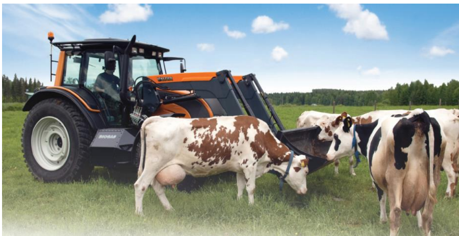
Slika 41: Traktor na pogon na dva goriva, dizelsko gorivo in bioplin, na desni stranispodaj pod kabino je viden rezervoar za bioplin (znotraj ohišja se nahajajo štiri jeklene posode narejene iz kompozitnega materiala, prostornina vsake posode znaša 42 l) skupne prostornine 168 l pri tlaku 200 bar (Valtra AGCO, serija N101 HiTech)
