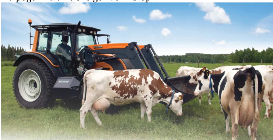
Slika 7. Traktor na pogon na dva goriva, dizelsko gorivo in bioplin, na desni stranispodaj pod kabino je viden rezervoar za bioplin (znotraj ohišja se nahajajo štiri jeklene posode narejene iz kompozitnega materiala, prostornina vsake posode znaša 42 l) skupne prostornine 168 l pri tlaku 200 bar (Valtra AGCO, serija N101 HiTech).
